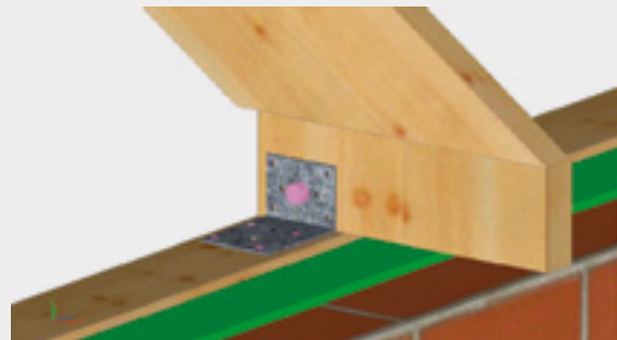
Fixation de l'équerre dans les fermettes en A sur poutre treillis.
